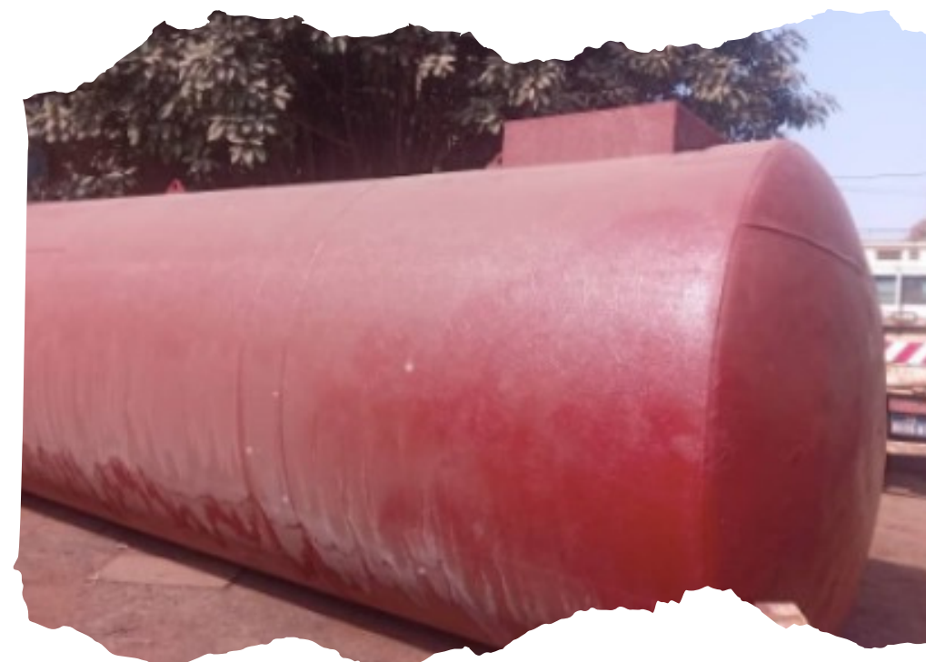
Projet de réalisation d'une cuve de 30m 3 double enveloppe Client VIVO ENERGY
